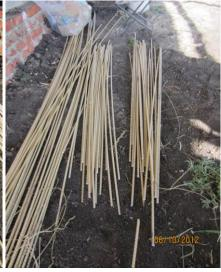
Стеклопластиковая арматура режется ножовкой по металлу. При порезке следите за тем, чтобы стеклопластиковая арматура не закусывала полотно ножовки — для этого **можно отгибать ее по направлению от пореза вниз**.
