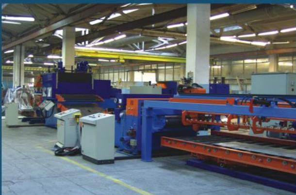
Автоматические линии поперечной резки рулонного металла, производимые компанией "Аркада-Инжиниринг", это эффективное и высокотехнологичное решение для резки металла на листы.
